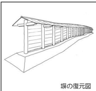
官衙の西側、政庁南大路に面していたところは、塀で囲まれていました。塀は、太さ25cmの柱が2.4~3.0m間隔で立てられ、その間は板壁でふさがれ、上には屋根がかけられていたと考えられます。再現工事では、塀の柱が立ち並んでいた様子を再現し、板壁と屋根は省略しています。
